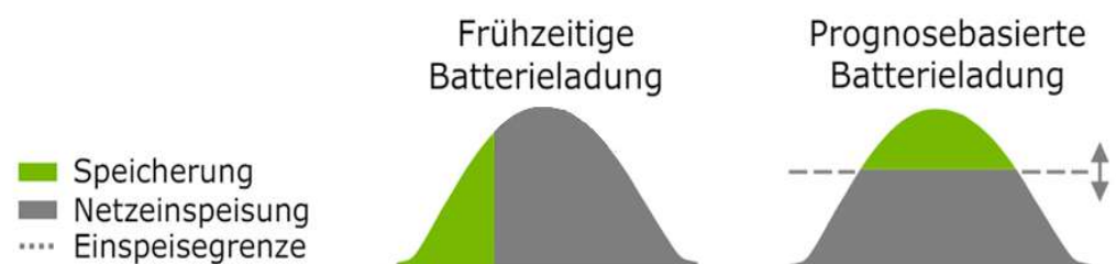
Abbildung 2: Vorzeitige vs. Prognosebasierte Batterieladung; eigene Darstellung, angelehnt an Weniger, Bergner, Tjaden, Quaschnig, Effekte der 50%-Einspeisebegrenzung des KfW-Förderprogramms für Photovoltaik-Speichersysteme, 2016 (Link).
