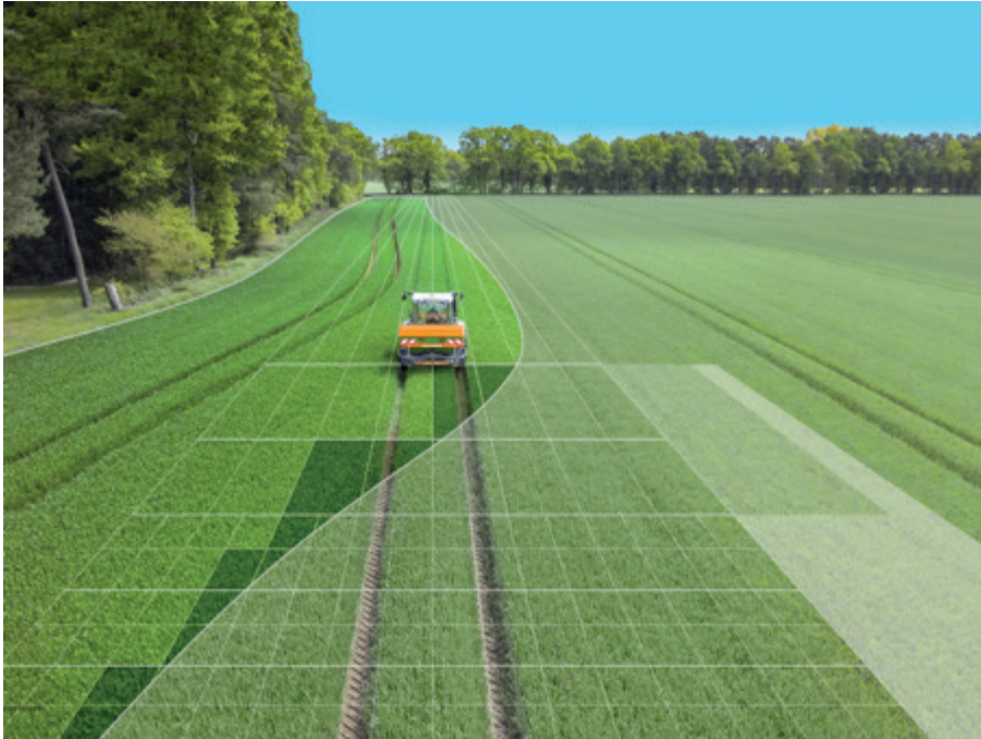
Abbildung 18: GPS-basiert arbeitende Teilbreiten- und Einzelreihenschaltungen reduzieren den Mittelaufwand und entlasten die Umwelt (Bild: Amazone).
