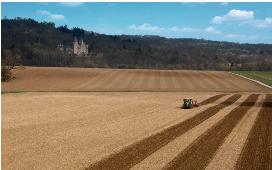
Abbildung 17: Automatische Lenksysteme und Fahrspurplanungsprogramme reduzieren den Ressourcenverbrauch unter vielen Gesichtspunkten (Bild: Claas).
