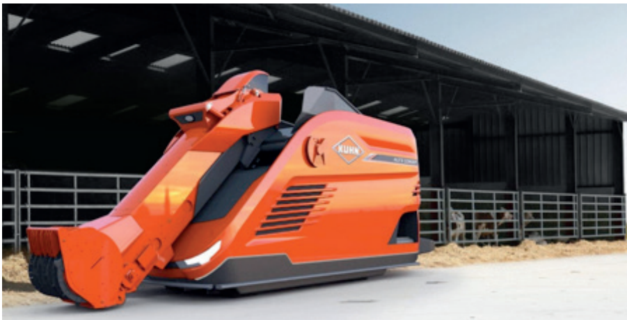
Abbildung 19: Autonomer Futtermisch- und Fütterungsroboter (Bild: Kuhn)
