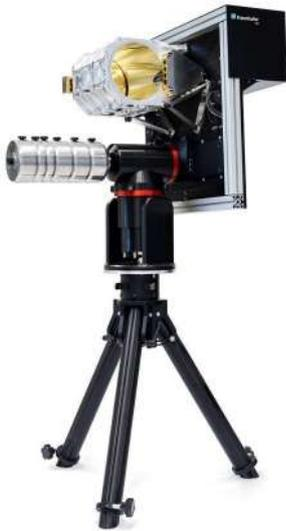
Teleskop für abhörsichere Quantenkommunikation Foto: Fraunhofer IOF
