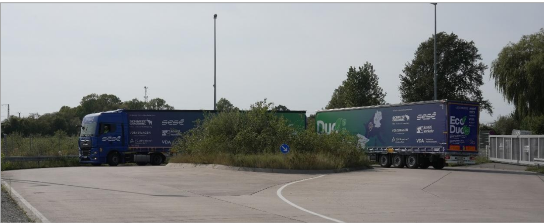
Abb. 6: Kurvenlauf der EcoDuo-Fahrzeugkombination (Quelle: Schmitz Cargobull AG)
