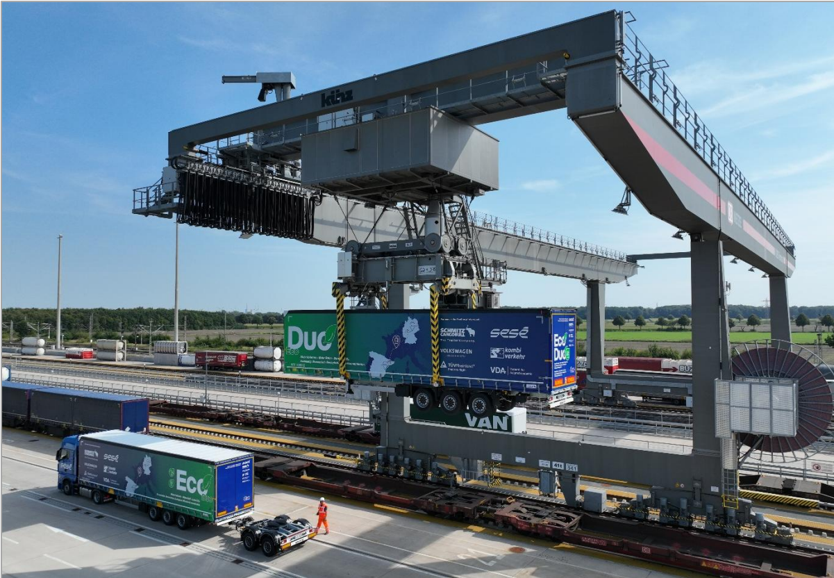
Abb. 7: Kranverladung der EcoDuo-Fahrzeugkombination auf den Waggon (Quelle: Schmitz Cargobull AG)
