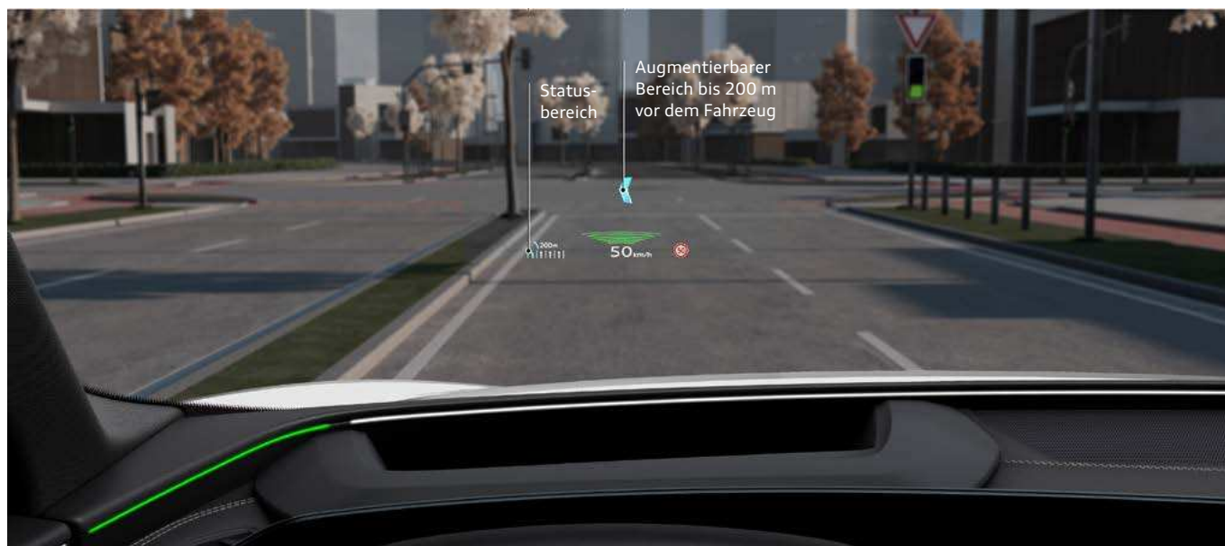
AR-HuD 6 im Audi Q6 e-tron: Die Anzeigen sind schnell erfassbar, ohne den Fahrenden zu irritieren.
