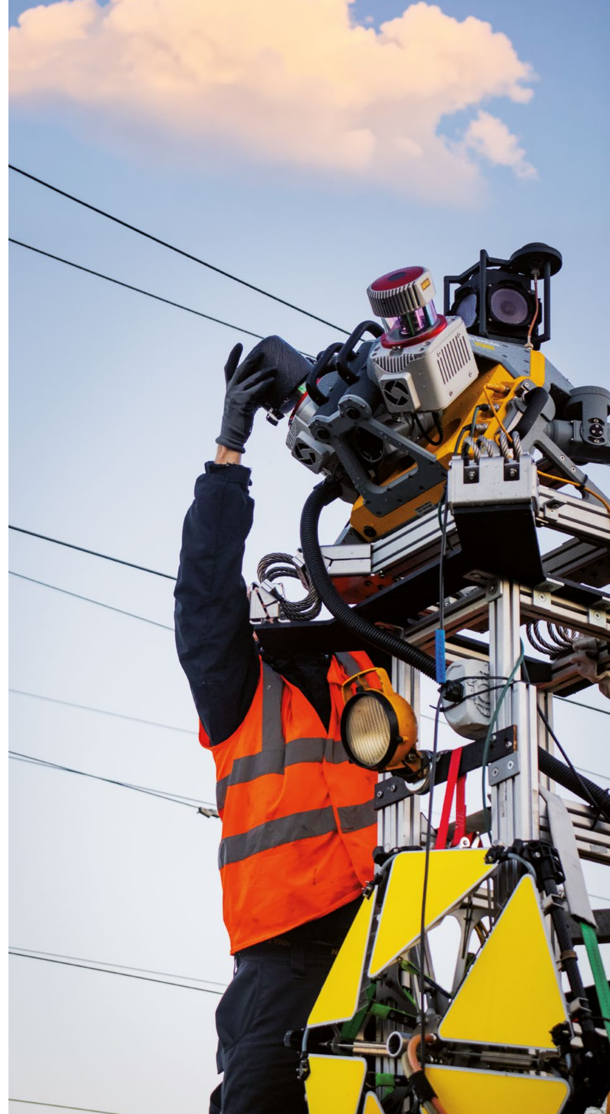
Aufbau und Systemcheck vor der Messfahrt: Sensoren und Halterungen werden geprüft – Systemchecks, Wartung und Ersatzsysteme sind fester Teil der Kampagnenlogistik.
