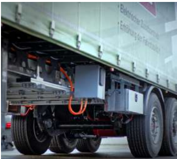
Autarkes elektrisches Antriebskooperationssystem für Lkw-Trailer und Fahrzeuganhänger Bild: evTrailer Zeichnung/ CuroCon GmbH
