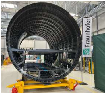
Das durch Thermoplastschweißen fertig gefügte Flugzeug-Rumpfssegment bei Fraunhofer in Stade Foto: Fraunhofer IFAM
