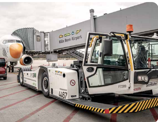
Dieser Flugzeugschlepper arbeitet rein elektrisch.
