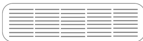
Abbildung 2.1.: Schematische Skizze der Körbe und Lagen innerhalb eines Autoklavs (Seitenansicht)
