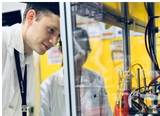
Messung an einem Teststand für die Wasserelektrolyse mit Polymer-Elektrolyt-Membran am Partnerinstitut in Südkorea
