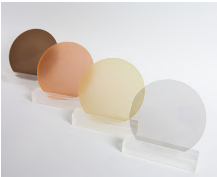
Die Herstellung von AlYN/GaN-Wafern im MOCVD-Verfahren, hier zu sehen in verschiedenen Yttrium-Konzentrationen, ist ein Durchbruch auf dem Gebiet der Halbleitermaterialien
