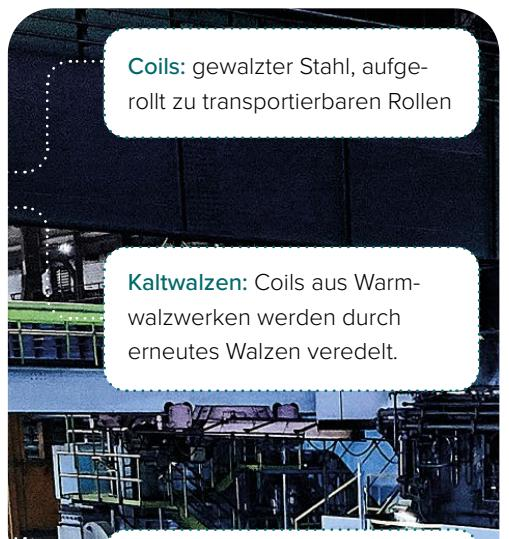
**Kaltwalzen:** Coils aus Warmwalzwerken werden durch erneutes Walzen veredelt.
