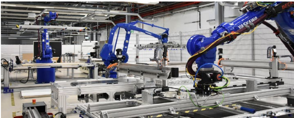
Eine Test-Montageanlage der TU Braunschweig zur automatisierten Montage der AWE-Elektrolysezellen mit Fokus auf Prozessverkettung
